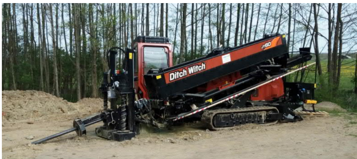
Figure 6: Exemple de machine utilisée pour la réalisation du forage dirigée (dimensions L = 8.4 \text{ m} \times l = 2.2 \text{ m} \times H = 2.6 \text{ m} )
